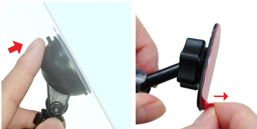
4. Ruotare la manopola in senso antiorario per allentare l'attacco e quindi regolare la posizione della DrivePro.
