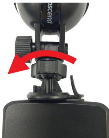
5. Dopo aver posizionato la DrivePro nella miglior posizione possibile, ruotare la manopola di regolazione in senso orario per assicurarsi che la DrivePro sia saldamente bloccata.
